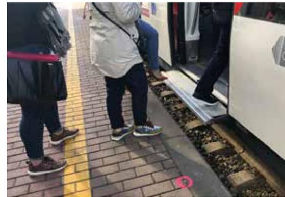
La reforma del badén, que muestra la imagen, ha eliminado la separación entre la plataforma de acceso del vagón y el andén.
